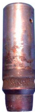
Rys. 5. Uszkodzenie grzyba zaworu w wyniku kawitacji
