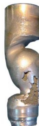
Rys. 6. Uszkodzenie grzyba zaworu w wyniku flashingu
