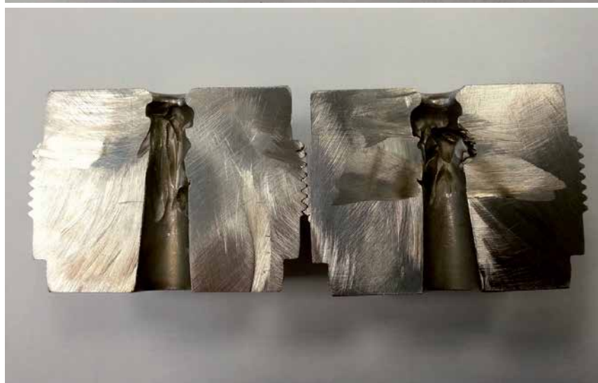
Fig. 5. Metalowe elementy wewnętrzne eksploatowanych zaworów.
