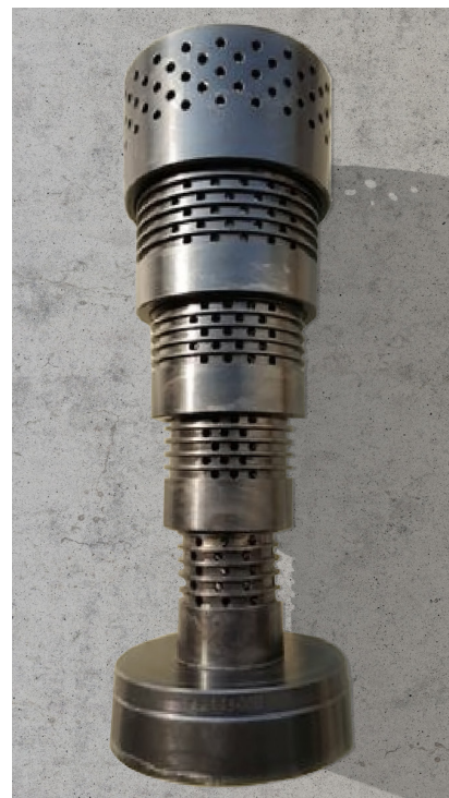
Rys. 5. Zespół klatek zaworu Z1B-M po inspekcji
