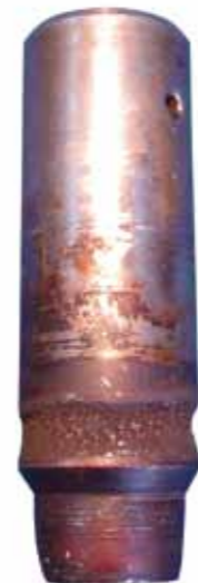
Rys. 5 Uszkodzenie grzyba zaworu w wyniku kawitacji
