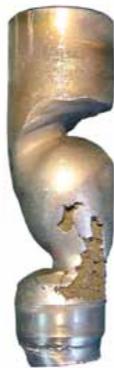
Rys. 6 Uszkodzenie grzyba zaworu w wyniku flashingu
